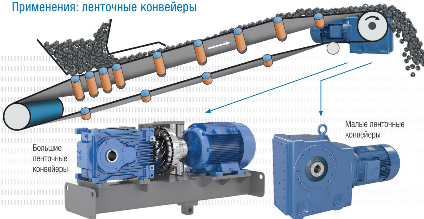
Ленточные конвейеры используются для непрерывной транспортировки сыпучих материалов. Они состоят из замкнутой конвейерной ленты, движение которой осуществляется с помощью опорных роликов. Лента используется для перемещения груза. Конвейеры обеспечивают экономичную транспортировку большого количества груза на большие расстояния. Длина конвейера колеблется от нескольких метров до нескольких
