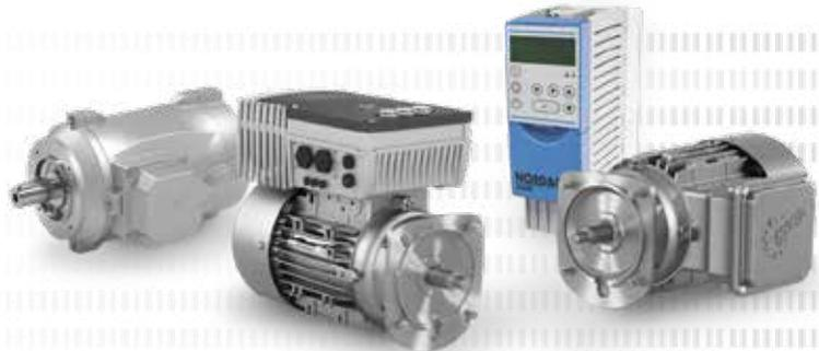
Hocheffiziente Motoren von NORD DRIVESYSTEMS sind Synchronmotoren, die auf Permanentmagnet-Technologie basieren. NORD hat sie speziell für den Betrieb am Getriebe konzipiert. Bereits bei kleinen Drehzahlen erreichen diese Systeme hohe Momente und außergewöhnlich hohe Effizienz. Die 4-poligen Motoren für energieoptimierte Anlagen sind ausschließlich für den Betrieb am Frequenzumrichter ausgelegt.
