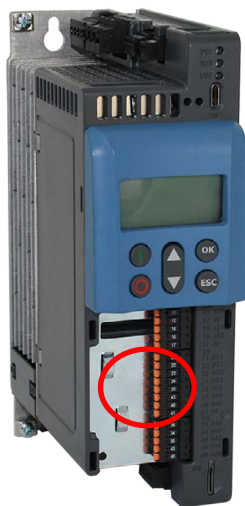
X12: дополнительные цифровые входы и выходы
