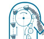
Ковшовый конвейер с отклоняющим роликом
