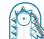
Ковшовый конвейер с сомкнутыми ковшами
