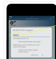
Si se le solicita un PIN, introduzca los últimos 6 dígitos del número de identificación que figura en la placa de características del NORDAC ACCESS BT y empareje los equipos.
