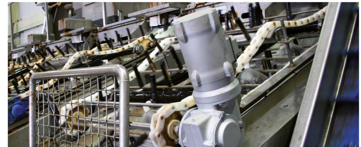
NORD motore a superficie liscia con nsd tupH
