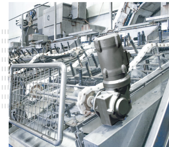
Réducteur à arbres parallèles MONOBLOC SK 0182.1 - SK 1382.1
