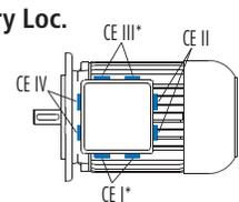
Mtg. Pos. M1 Shown \* Brakemotor Mtg. Pos. M1 Shown
