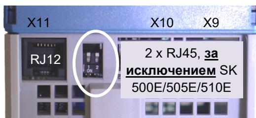
Рисунок 10: Верхняя часть устройства с соединением RJ12-/ RJ45
