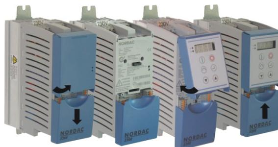
Убедиться, что модуль имеет контакт с колодкой штекерных разъемов, при необходимости закрепить его с помощью подходящего винта. (винт самонарезающий по металлу 2,9 мм х 9,5 мм, прилагается к преобразователю частоты).
