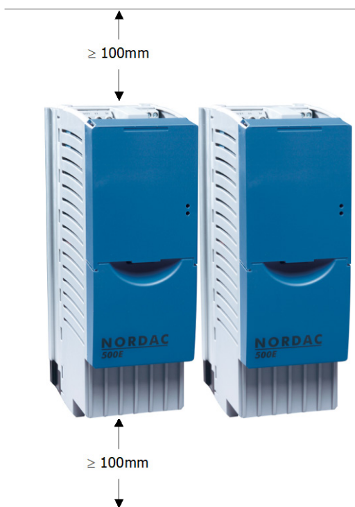
Рис. 1: Монтажные расстояния SK 5xxE
