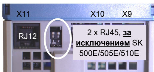
Рисунок 10: Верхняя часть устройства с соединением RJ12-/ RJ45
