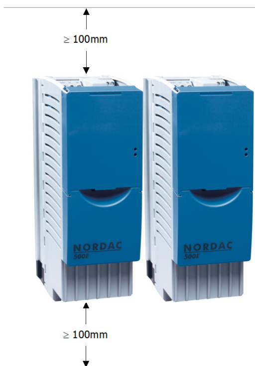
Figura 1: distanze di montaggio SK 5xxE
