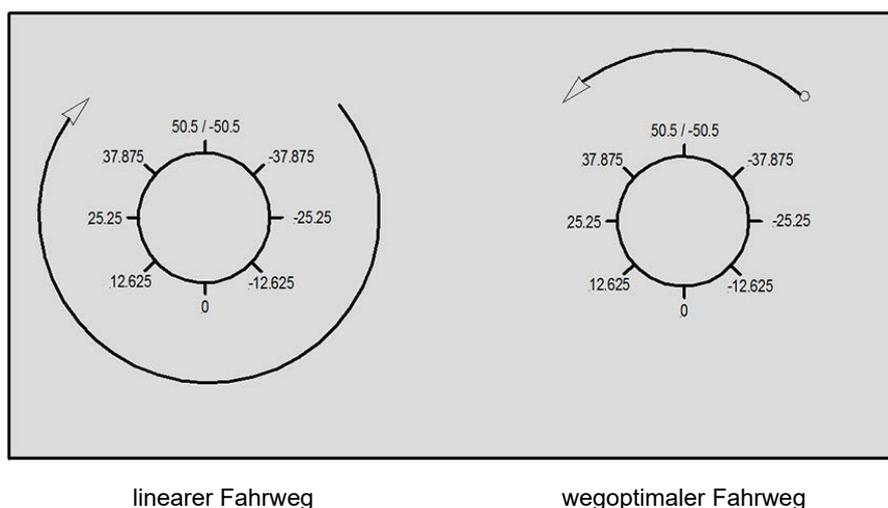
Abbildung 2: Rundtischpositionierung bei einer Multiturn-Anwendung
