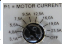
Рисунок: P1 пускового устройства двигателя на 7,5 кВт
