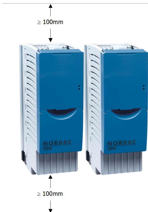
Abbildung 1: Montageabstände SK 5xxE
