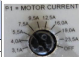
Abbildung: P1 eines 7,5 kW Motorstarters
