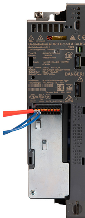
Fixieren der Anschlüsse (dritte Hand)
