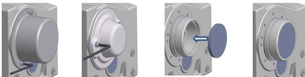
Εικόνα 13: Συναρμολόγηση του καλύμματος επιλογή SH, επιλογή H και επιλογή H66
