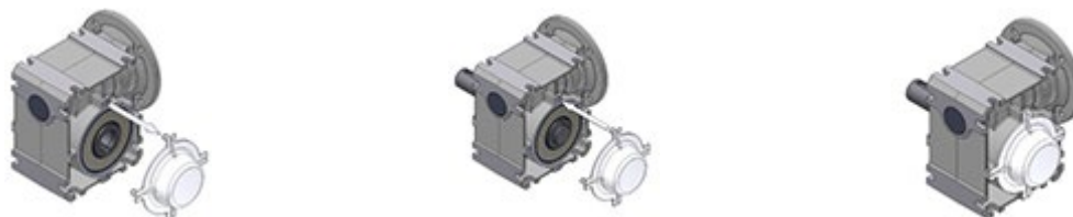
Εικόνα 14: Αποσυναρμολόγηση και συναρμολόγηση του καλύμματος
