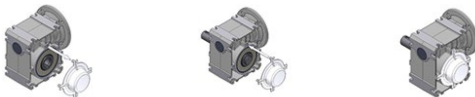
Slika 14: demontaža i montaža pokrivne kapice
