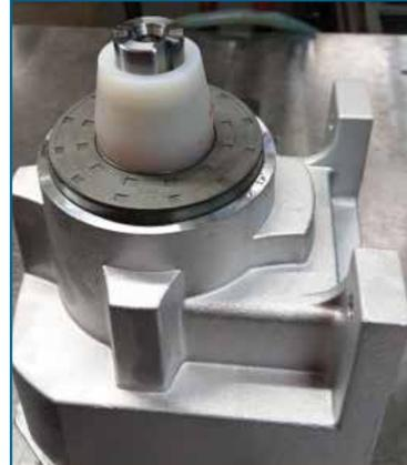
6. Mettre l'outil de pression pour bagues d'étanchéité au-dessus de l'arbre de sortie et appuyer sur la bague en tapant avec précaution à l'aide d'un marteau en plastique.
