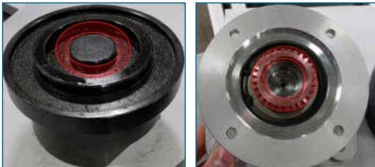
12. Selon le diamètre de l'arbre, choisir l'outil de filetage adapté et frapper avec précaution le pignon avec un marteau en plastique dans sa position définitive.
