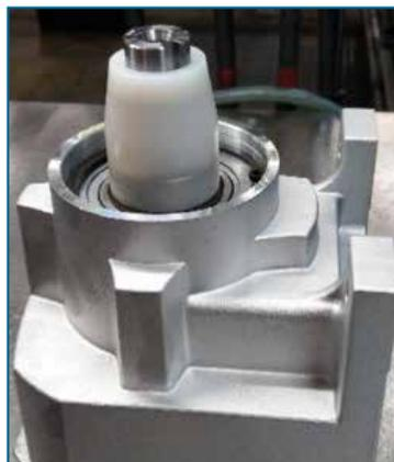
5. Poser la bague d'étanchéité à l'aide de la douille sur le carter.
