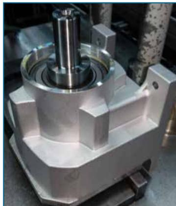
2. Positionner les rondelles de réglage sur le palier.
