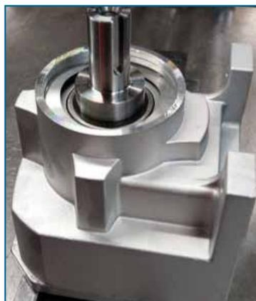
3. Monter le circlip à l'aide de la pince pour circlips.
