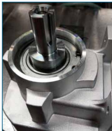
4. Mettre la douille de serrage pour bague d'étanchéité au-dessus de l'arbre de sortie.
