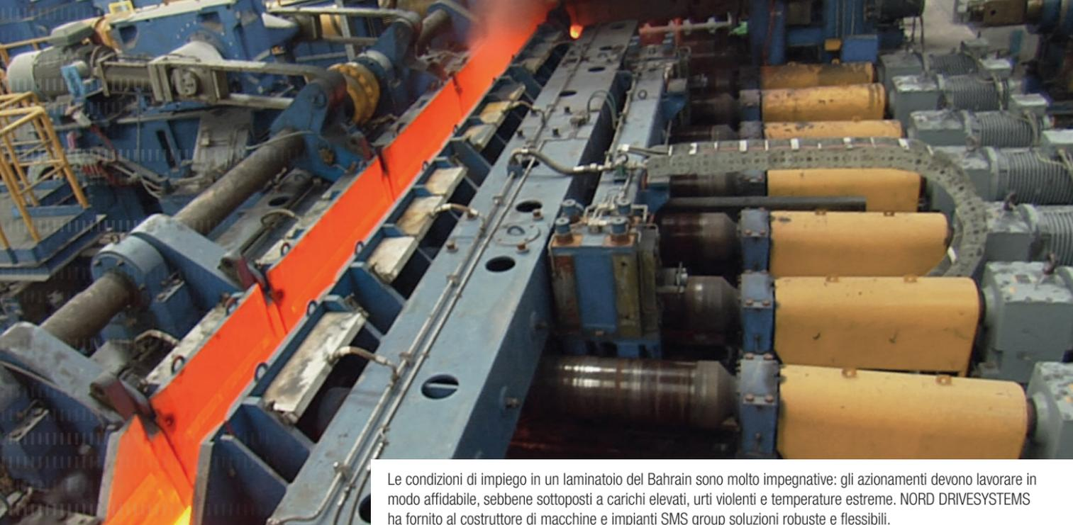
Le condizioni di impiego in un laminatoio del Bahrain sono molto impegnative: gli azionamenti devono lavorare in modo affidabile, sebbene sottoposti a carichi elevati, urti violenti e temperature estreme. NORD DRIVESYSTEMS ha fornito al costruttore di macchine e impianti SMS group soluzioni robuste e flessibili.
