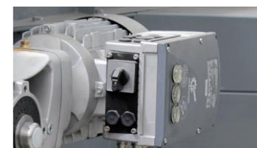
Interruttori e pulsanti si trovano sugli azionamenti e permettono di impartire direttamente i comandi di avvio e di arresto e di cambiare modalità.
