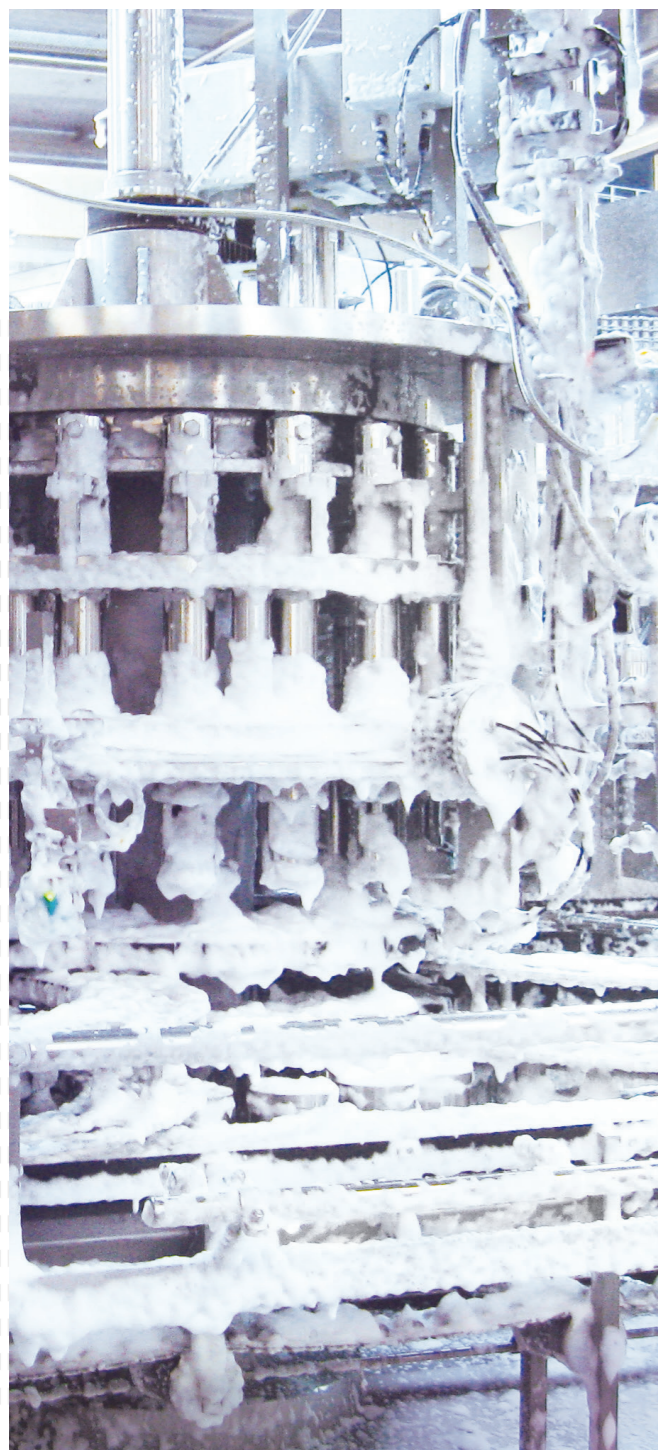
Lavaggio a schiuma di un impianto di imbottigliamento
