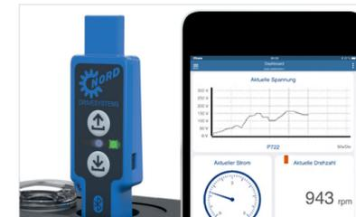
Le tableau de bord apparaît et la DEL d'état bleue est allumée. La clé NORDAC ACCESS BT est à présent connectée à l'appareil terminal.
