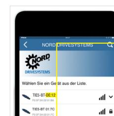
Parcourez les appareils visibles et sélectionnez la clé NORDAC ACCESS BT (TIE5-BT-DE:12). Une fois les modules scannés, la DEL d'état bleue clignote rapidement.
