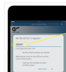
Si le code PIN est demandé, utilisez les 6 derniers chiffres du numéro ID de la plaque signalétique de NORDAC ACCESS BT et connectez les appareils.
