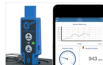
Le tableau de bord apparaît et la DEL d'état bleue est allumée. La clé NORDAC ACCESS BT est à présent connectée à l'appareil terminal.
