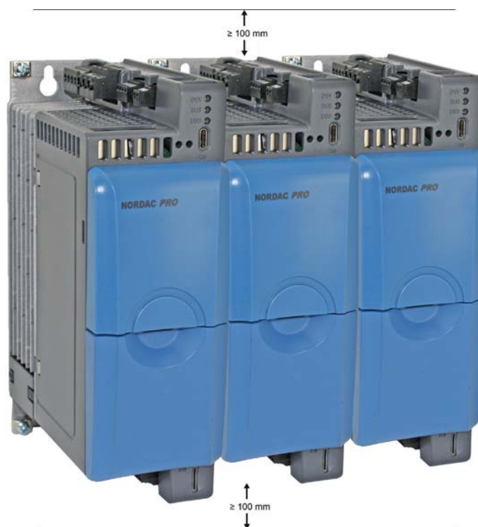
Rysunek 1: Odległości montażowe
