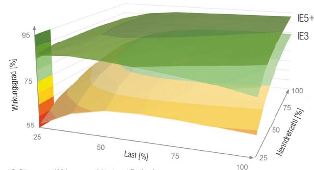
3D-Diagramm: Wirkungsgrad, Last und Drehzahl
