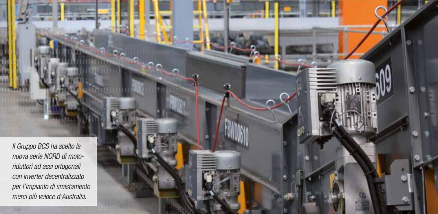
Il Gruppo BCS ha scelto la nuova serie NORD di motoriduttori ad assi ortogonali con inverter decentralizzato per l'impianto di smistamento merci più veloce d'Australia.
