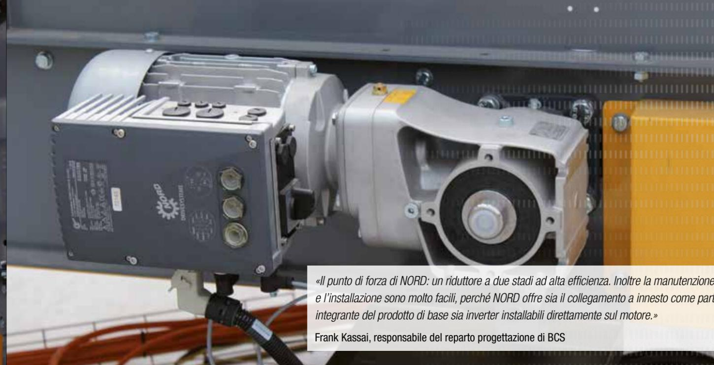
«Il punto di forza di NORD: un riduttore a due stadi ad alta efficienza. Inoltre la manutenzione e l'installazione sono molto facili, perché NORD offre sia il collegamento a innesto come parte integrante del prodotto di base sia inverter installabili direttamente sul motore.»
