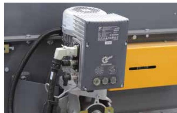
Variateurs de fréquence : Installation facile par fiche de raccordement
