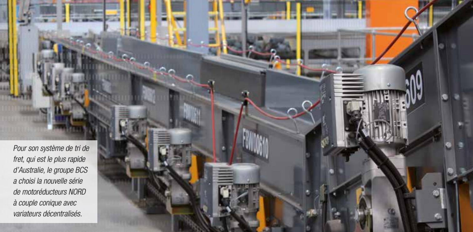
Pour son système de tri de fret, qui est le plus rapide d'Australie, le groupe BCS a choisi la nouvelle série de motoréducteurs NORD à couple conique avec variateurs décentralisés.
