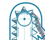
Ковшовый конвейер с сомкнутыми ковшами
