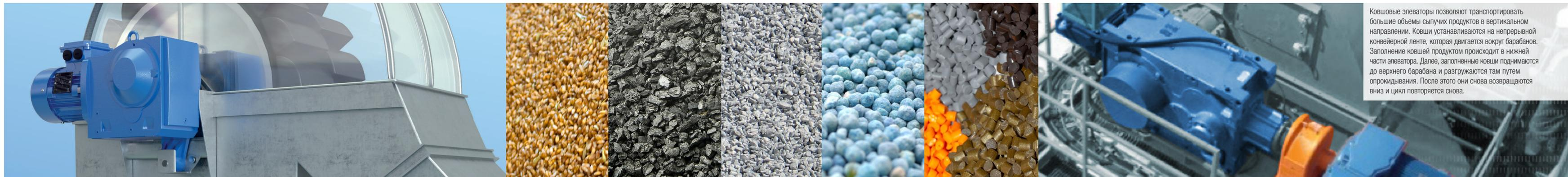
Ковшовые элеваторы позволяют транспортировать большие объемы сыпучих продуктов в вертикальном направлении. Ковши устанавливаются на непрерывной конвейерной ленте, которая движется вокруг барабанов. Заполнение ковшей продуктом происходит в нижней части элеватора. Далее, заполненные ковши поднимаются до верхнего барабана и разгружаются там путем опрокидывания. После этого они снова возвращаются вниз и цикл повторяется снова.
