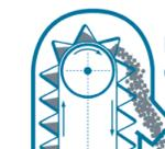
Ковшовый конвейер с сомкнутыми ковшами
