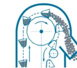
Ковшовый конвейер с отклоняющим роликом
