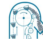
Ковшовый конвейер с отклоняющим роликом
